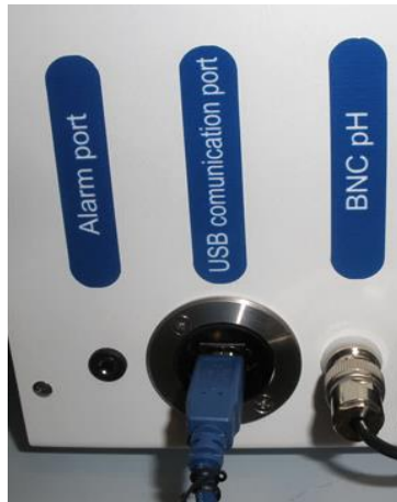
Figuur 20.1 pH-sonde aangesloten op de BNC
