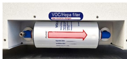
Figuur 12.3 Correct geïnstalleerd VOS/HEPA filter
