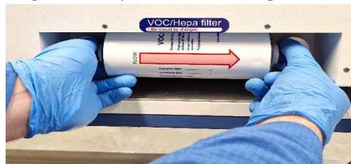
Figuur 12.2 VOS/HEPA filter plaatsen en verwijderen
