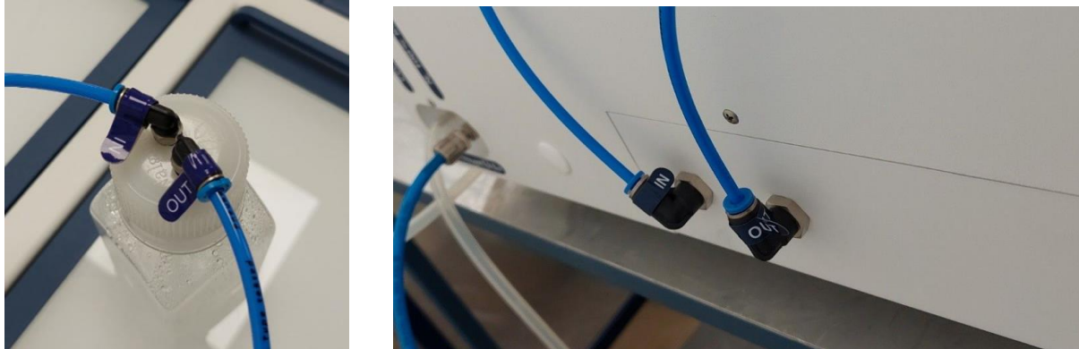
Figuur 23.1 Slangaansluiting op de bevochtigingsfles en de MIRI® Humidity IVF incubator met meerdere kamers
