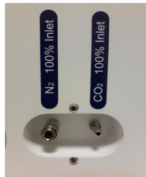
Figuur 11.1 Gasinlaten aan de achterkant van MIRI® en MIRI® Humidity IVF incubatoren met meerdere kamers
